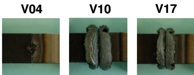
V04:  $D_S=1,5\text{mm}$ ;  $f=160\text{Hz}$ ;  $t_R=3\text{s}$ ;  $p_R=0,5\text{bar}$ ;  $p_{St}=1,0\text{bar}$
