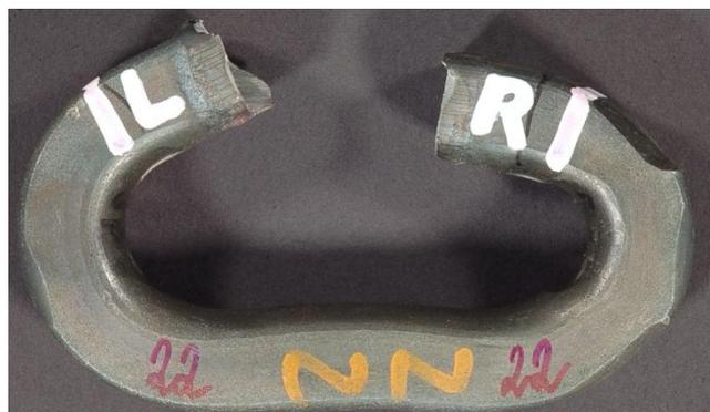
Abbildung 1: Abbrennstumpfgeschweißtes Kettenglied (Schweißbruch)
