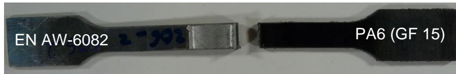
Abbildung 4: Scherzugprobe einer RPF-gefügtten Al-PA-Verbindung (Aluminiumoberfläche gestraht)
